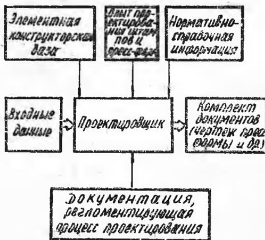
Рис. 41. Схема процесса «ручного» проектирования технологического процесса ОМД
