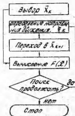
Рис. 28. Схема вычислений при поисковой оптимизации
