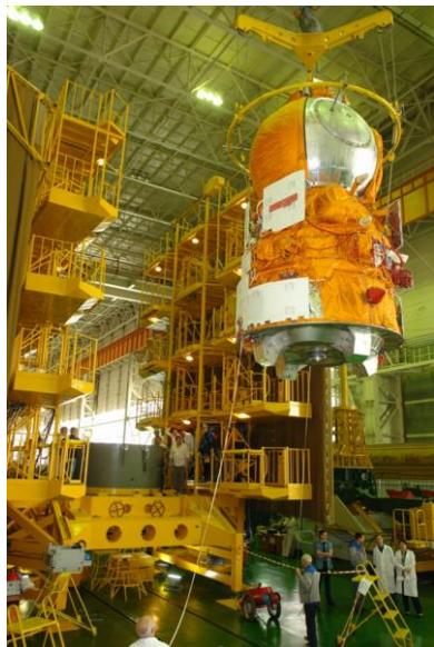
Рис. 4.8. Установка КА «Бион-М» №1 в испытательный стенд
