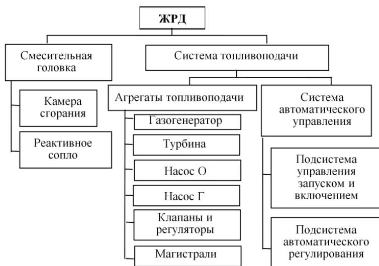
Рис. 3.2. Состав типового маршевого ЖРД
