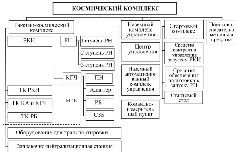
Рис. 1.1. Типовая структура космического комплекса
