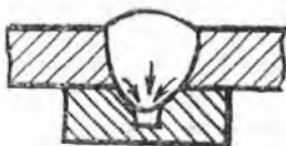
Рис. 3.3. Схема образования проплава при сварке, обеспечивающей формирование центральной части проплава на весу
