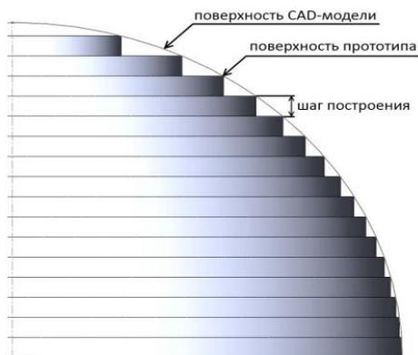
Рис. 14. Послойный принцип построения модели на 3D-принтере Objet Eden 350
