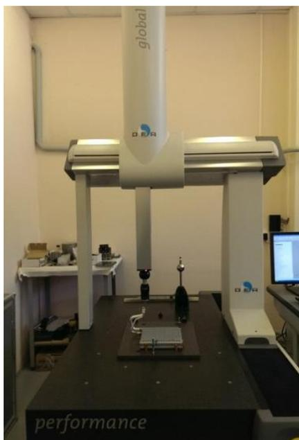
Рис. 35. Процесс измерения детали на КИМ «DEA Global Performance 07.10.07»
