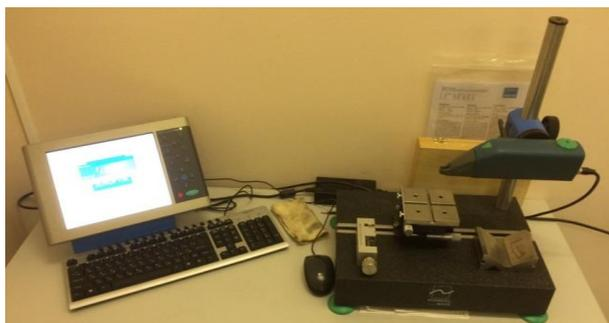
Рис. 19. Внешний вид профилометра Hommel Wave
