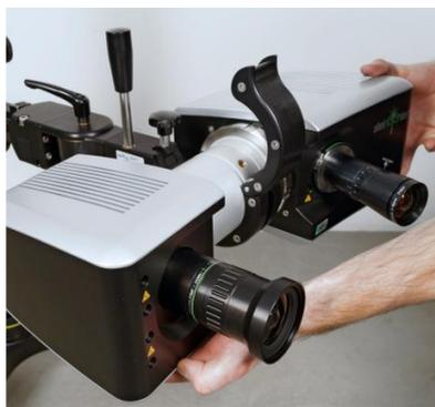
Рис. 52. Установка датчика СОМЕТА 6 в трехкоординатную головку
