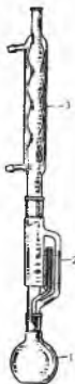
Рис.18. Общий вид установки для обезжиривания растительного материала: 1 – колба-испаритель, 2 – насадка Сокслета, 3 – обратный холодильник
