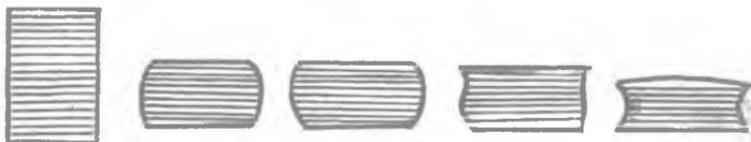
Р и с. 12. Образцы, деформированные с различными скоростями  $\dot{\epsilon} = 0,5$  /: слева направо - исходная заготовка; деформация со скоростью соответственно  $V = 0,001$  м/с;  $V = 25$  м/с;  $V = 50$  м/с;  $V = 100$  м/с
