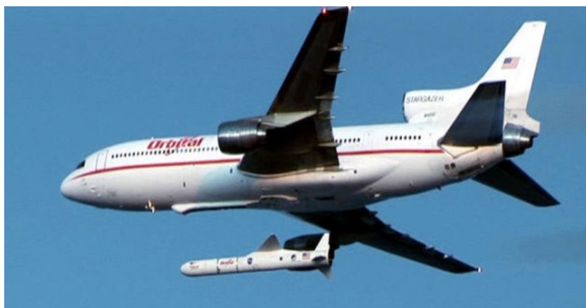
Рис. 1.2. Пример КРК воздушного базирования на базе самолета L-1011 Stargazer и РН Pegasus
