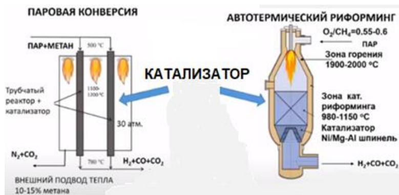
Рисунок 7 – Паровая конверсия природного газа
