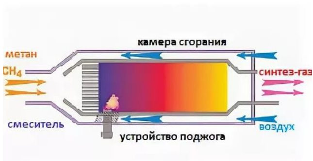
Рисунок 12 – Схема установки получения водорода на основе процесса горения, реализуемого аналогично камере ЖРД
