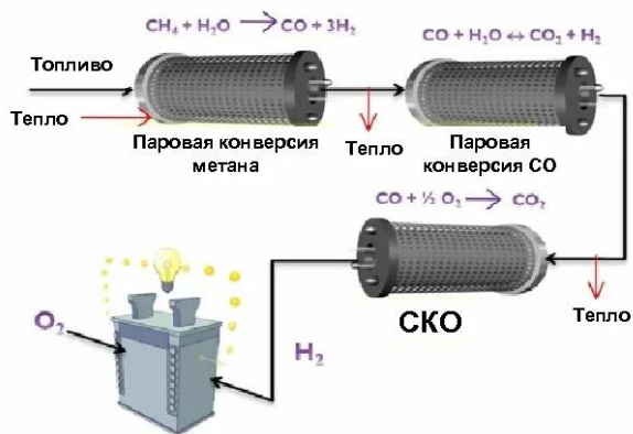
Рисунок 10 – Схема селективного каталитического окисления монооксида углерода, применяемая для снижения углеродного следа
