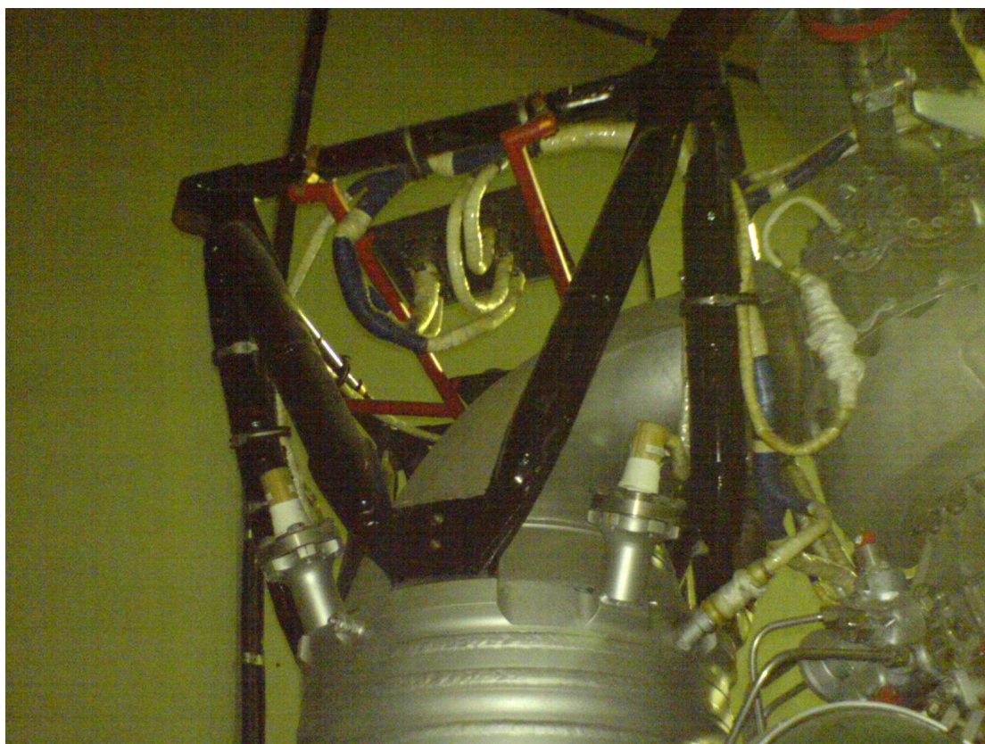
Рисунок 13 - Узел крепления ЖРД НК-33, представляющий собой раму, установленную на силовом кольце смесительной головки
