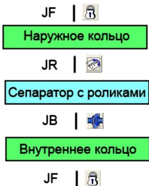
Рисунок 29 - Кинематическая схема подшипника
