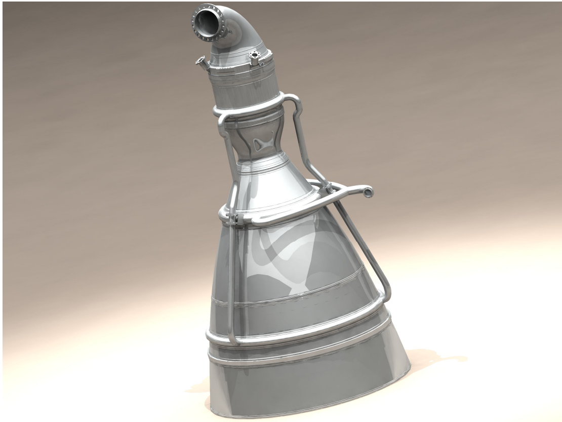
Рисунок 12 - Общий вид камеры ЖРД НК-33 (фотореалистичная модель камеры)
