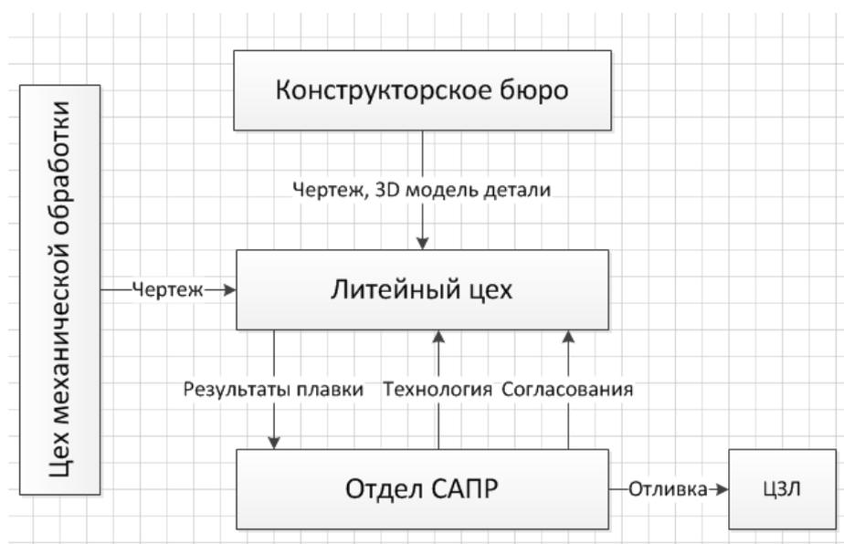
Рисунок 8 – Разработка технологии изготовления отливок с использованием аддитивных технологий
