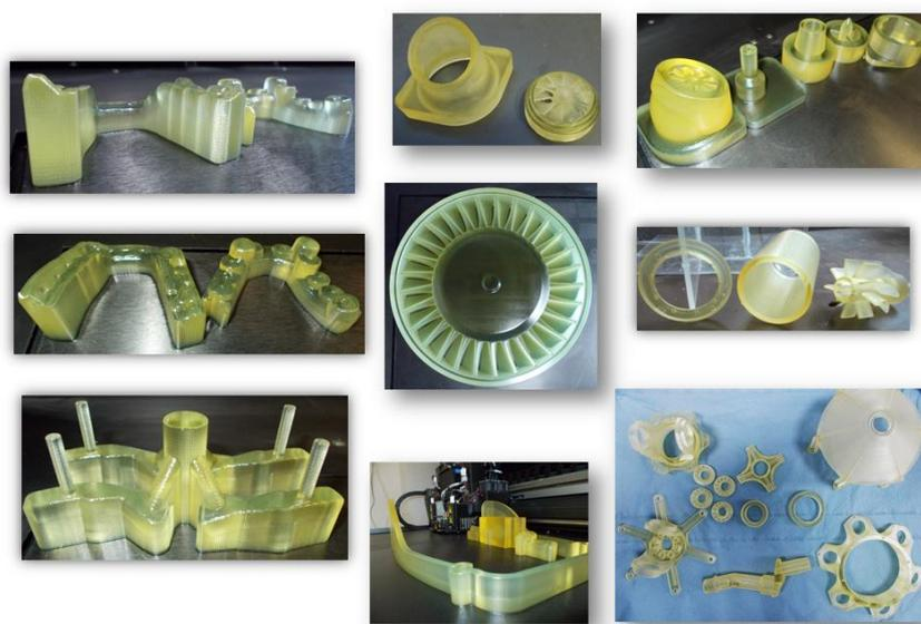
Рисунок 5 – Детали, получаемые 3D печатью
