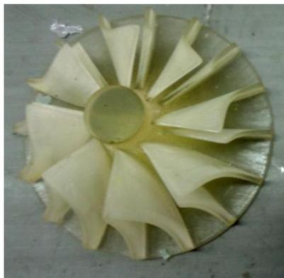
Рисунок 27 - Изготовленная мастер-модель детали «Крыльчатки»
