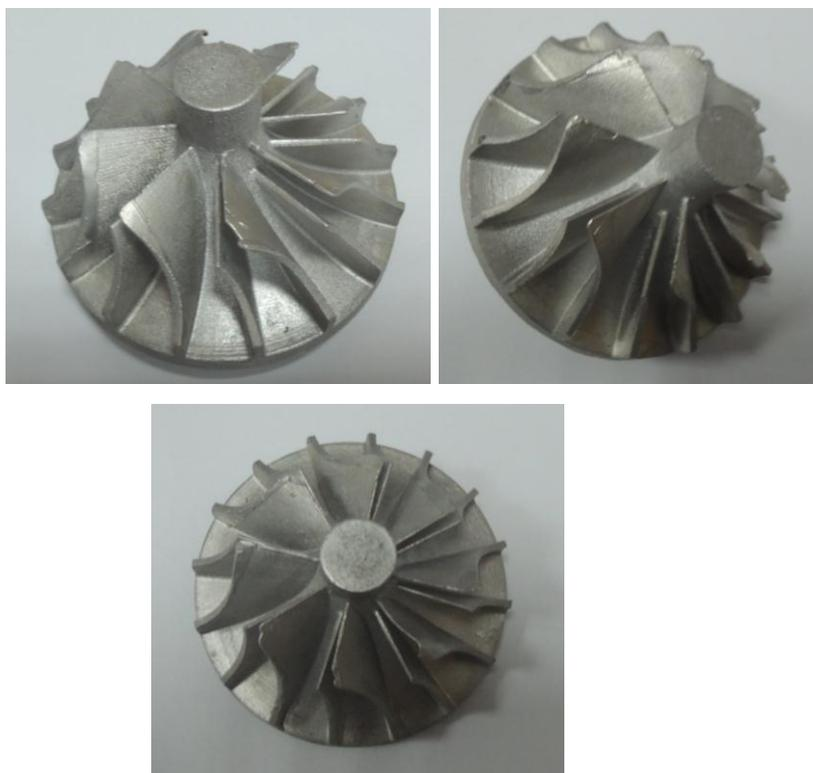
Рисунок 30 – Отливка детали
