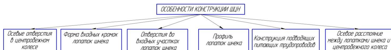
Рисунок 3 – Особенности конструкции шнеко-центробежного насоса
