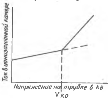
Рис.18. Зависимость интегральной интенсивности от напряжения на трубке
