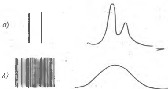
Рис. 49. Искажения кристаллической решетки и вид рентгенограммы: а - рентгенограмма и распределение интенсивности по ширине спектральной линии, полученной с образца без искажений кристаллической решетки; б - то же с образца с искажением кристаллической решетки
