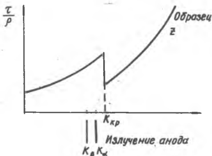
Рис.22. Схема образования рассеянного излучения в результате селективного поглощения в исследуемом образце
