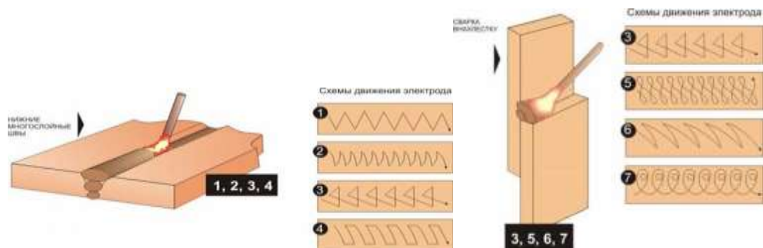
Рис. 3.9. Схемы движения электрода при сварке стыковых и нахлесточных соединений
