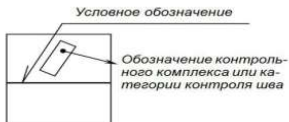
Рис. 3.21. Обозначение контрольного комплекса шва на чертеже
