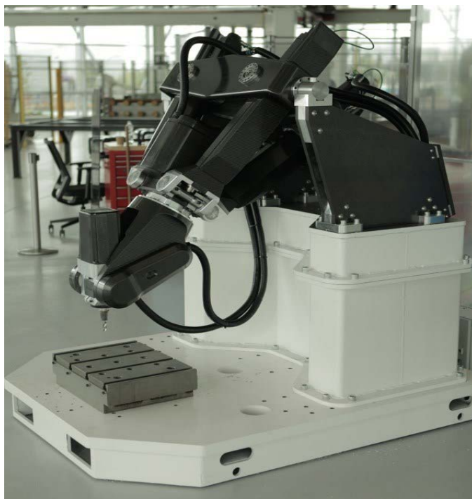
Рис. 3.8. Фрезерно-сверлильный станок XMini с параллельной кинематикой (производитель Ezechon, GmbH , Германия)
