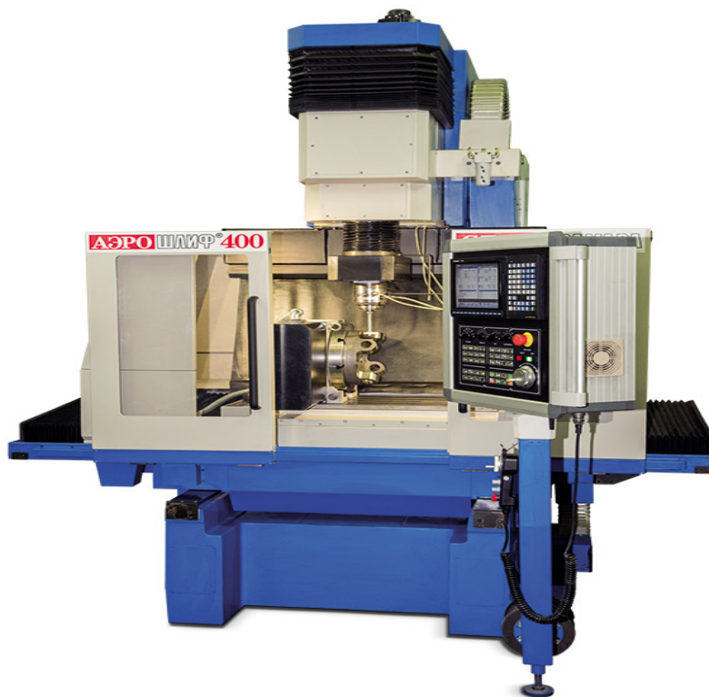
Рис. 3.9. Вертикальный координатно-шлифовальный станок особой точности мод. Аэрошлиф 400(производитель ЗАО «Стан-Самара» г. Самара)
