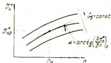
Рис. 2.20. Зависимость степени повышения давления \pi_{к}^* на компрессоре от частоты вращения n при различных значениях G_B = \text{const}
