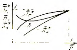
Рис. 1.6. График изменения относительных параметров при дроселировании двигателя
