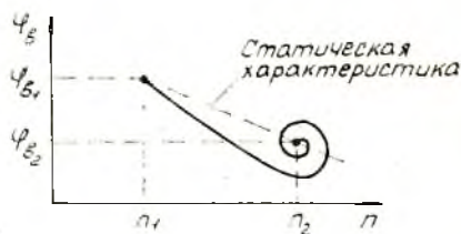
Рис. 7.6. Зависимость угла установки \varphi_{в} от частоты вращения n в САР ТВД во время переходного процесса
