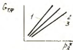
Рис. 5.2. Зависимость требуемого расхода топлива G_{\phi} от давления p_b^* при различных температурах T_b^* : 1 — (T_b^*)_1 ; 2 — (T_b^*)_2 > (T_b^*)_1 ; 3 — (T_b^*)_3 > (T_b^*)_2
