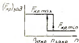
Рис. 4.8. Программа ступенчатого изменения F_{кр} в зависимости от частоты вращения n
