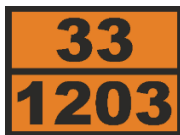
Рис. 11. Код угрозы 33 на табличке расшифровывается как легковоспламеняющаяся жидкость, легковоспламеняющийся газ, кодировка ООН 1203 обозначает бензин
