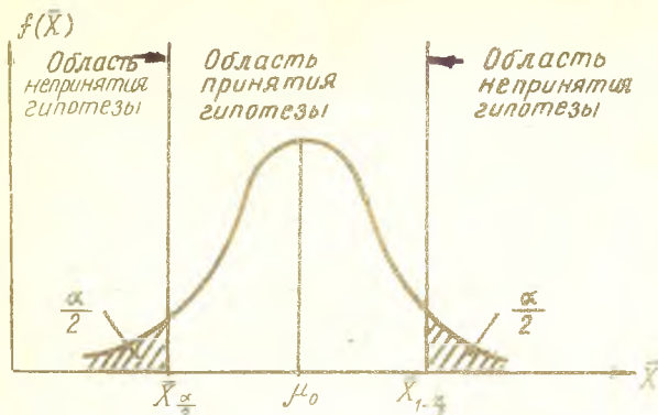
Р и с.15. Области принятия и непринятия нулевой гипотезы при конкурирующей H_1: \mu \neq \mu_0
