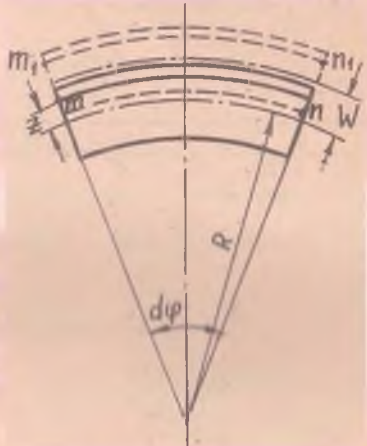
Рис.2.2. Деформация сечения оболочки в окружном направлении
