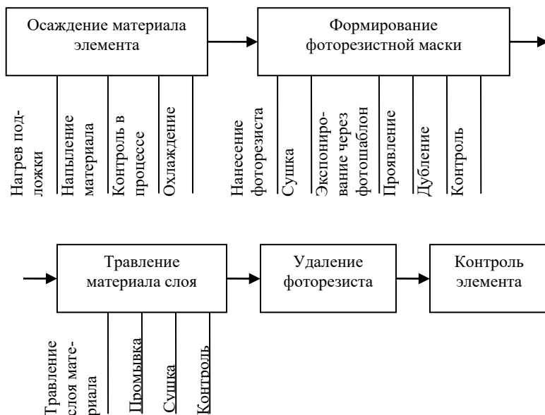
Рис. 17. Схема техпроцесса последовательности изготовления тонкопленочного элемента
