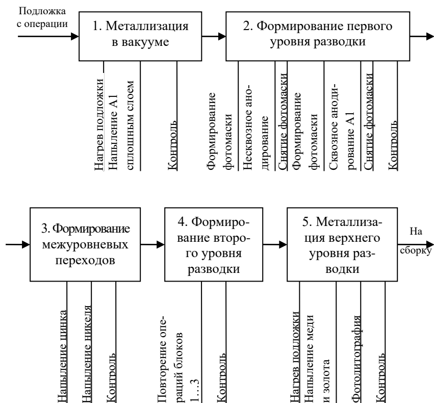
Рис. 51. Технологический маршрут формирования трехуровневой разводки на основе последовательного анодирования напыляемых пленок алюминия
