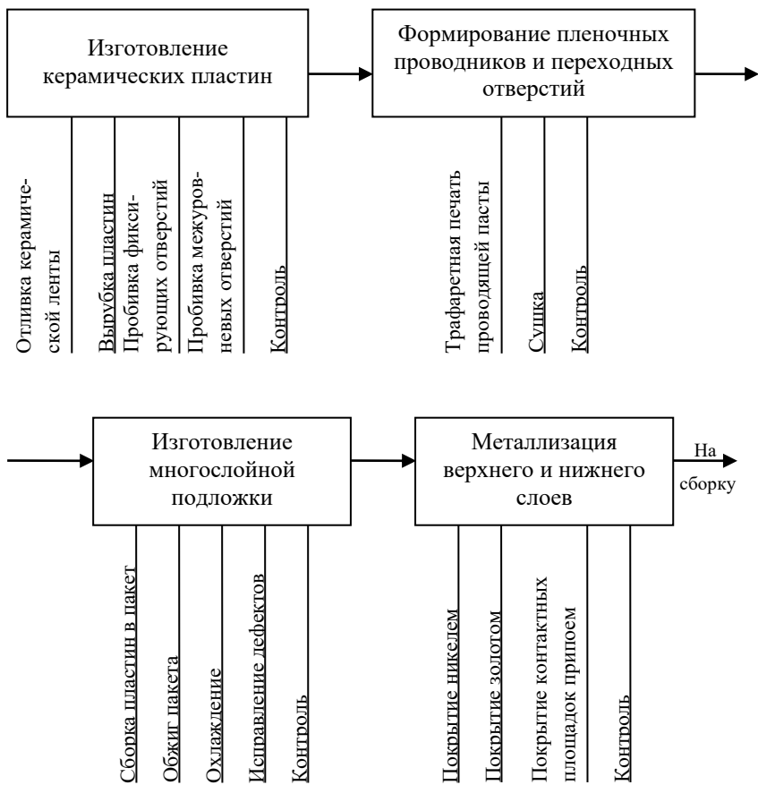
Рис. 50. Технологический маршрут изготовления многослойной керамической подложки
