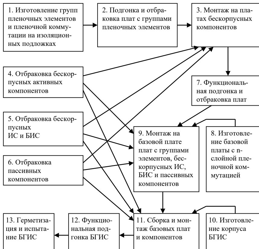
Рис. 4. Укрупненная схема технологического процесса изготовления БГИС
