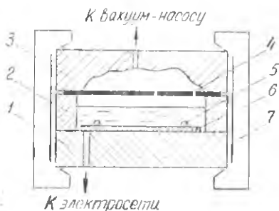
Рис. 1.1. Схема штамповки металлом передающей среды: 1—основание, 2—прижим, 3—матрица, 4—заготовка, 5—заряд, 6—защитный слой, 7—крепление
