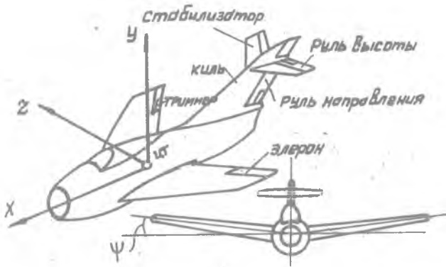
Рис. II. Органы устойчивости и управляемости самолета установившийся режим возможен в том случае, когда все силы и моменты, действующие на самолет, находятся в равновесии. Уравновешивание или балансировка самолета в продольной плоскости (рис. I2) требует выполнения трех условий:
