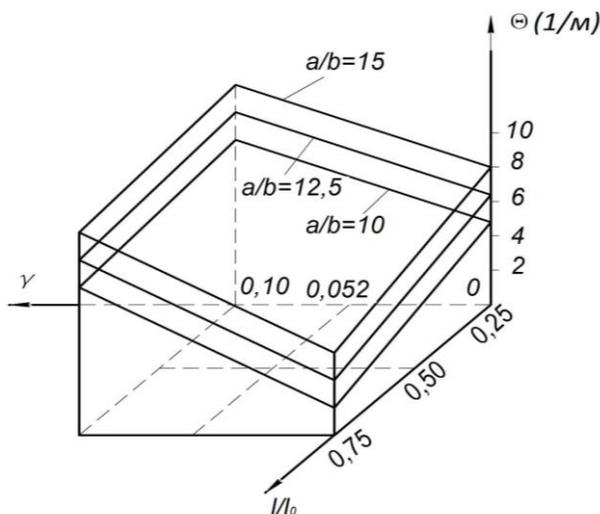
Рис. 23. Влияние параметров матрицы на угол закрутки
