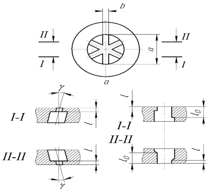
Рис. 22. Матрица для прессования винтовых профилей
