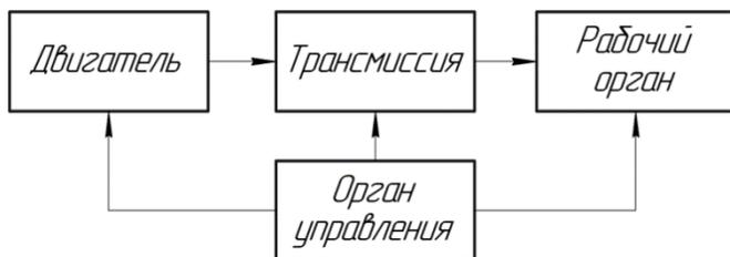
Рис. 9. Формальная структура технических систем
