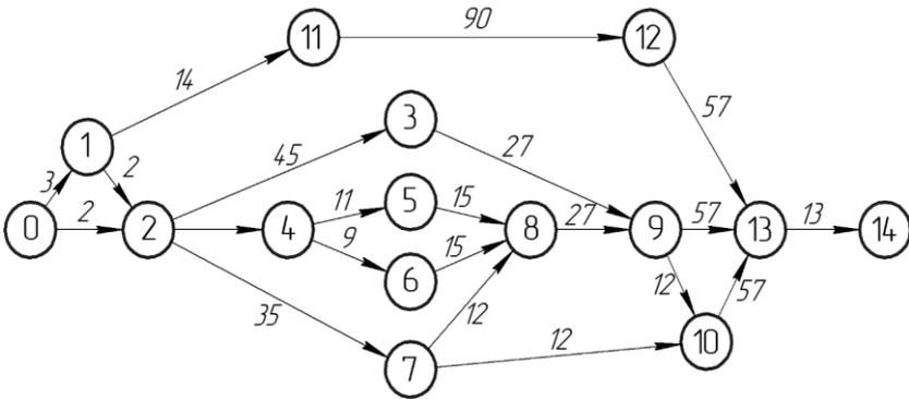
Рис. 34. Сетевой график проведения эксперимента по комплексному исследованию процесса прокатки
