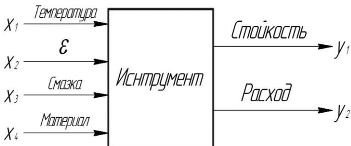
Рис. 21. Описание входных и выходных параметров системы «штамп» в процессе горячей объемной штамповки
