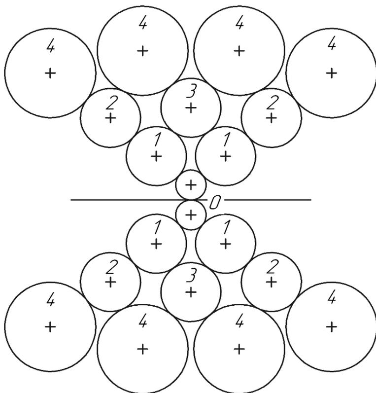
Рис. 16. Конструктивный вид валков прокатного стана Сендзимира:
