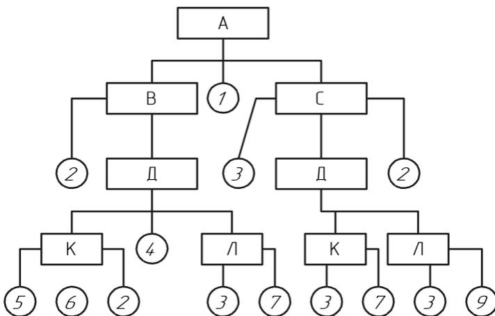
Рис. 14. Иерархическая структура материальных потоков сборки изделия А
