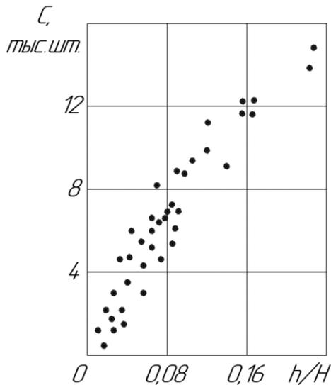
Рис. 20. Поле корреляции стойкости молотового штампа  $C$  от отношений высоты облойной канавки  $h$  к высоте поковки  $H$
