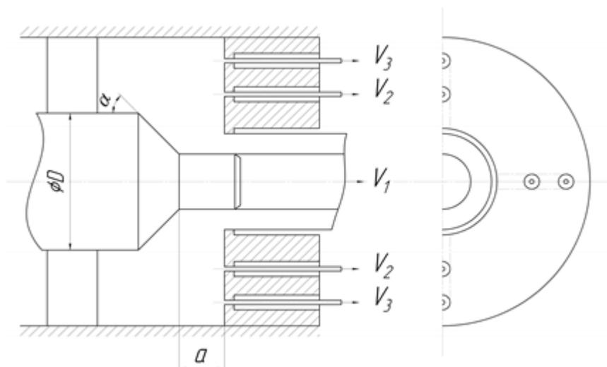
Рис. 47. Схема прессования труб с наружным продольным оребрением
