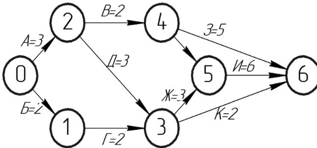
Рис. 30. Сетевая модель процесса изготовления детали
