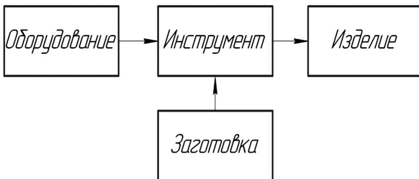
Рис. 8. Формальная структура процессов пластического деформирования металлов
