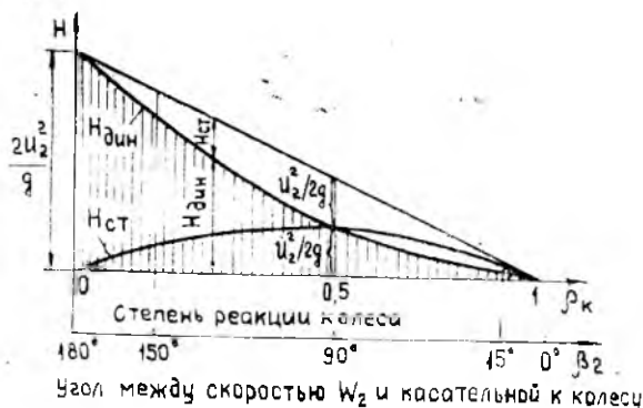
Рис. 2.18. Зависимость напора центробежного насоса от степени реакции колеса или угла
