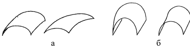
Рис. 2.1. Классификация оболочек двойной кривизны: а – оболочки с постоянными радиусами по главным сечениям; б – оболочки с переменными радиусами по главным сечениям
