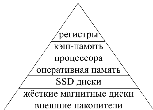
Рис. 1. Иерархическая структура памяти ЭВМ
