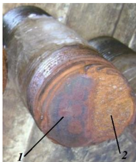
Рис. 1.13. Излом шпильки: 1 – зона усталостного излома; 2 – зона долома
