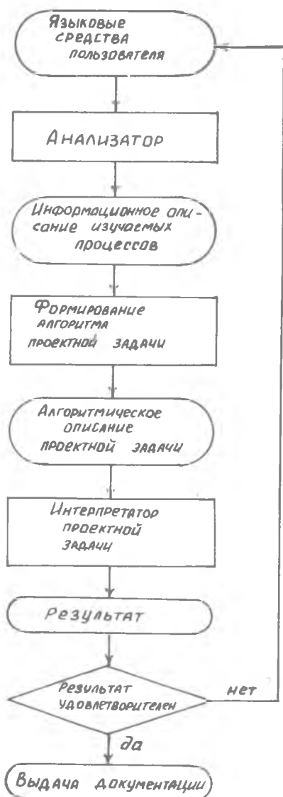
Р и с. 4.1. Общая структурная схема базовой САиР
