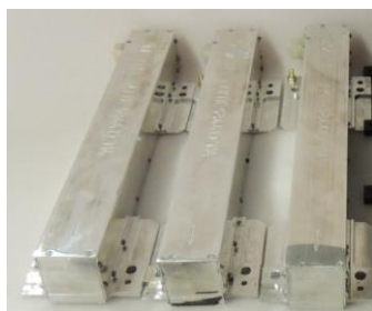
Рис. 3.25. Пример внешнего облика силовых электромагнитов для управления ориентацией малого КА
