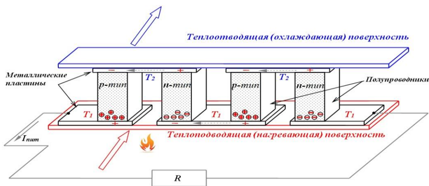
Рис. 3.36. Упрощенная схема принципа работы термоэлектрического полупроводникового генератора
