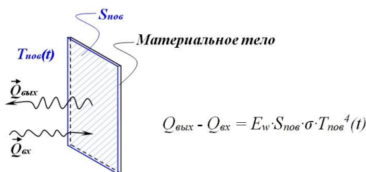
Рис. 3.41. К определению лучистого теплообмена
