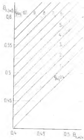
Рис. 3.18. Зависимость эквивалентной эффективности охлаждения рабочей лопатки турбины ВД \Theta_{\text{л экв}} от расхода воды \bar{g}_{\text{вод}} , введенной в воздух, охлаждающий ротор, и исходного значения \Theta_{\text{л исх}} :
