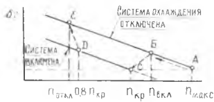
Рис. 4.6. Зависимость радиального зазора в турбине двигателя от частоты вращения ротора при наличии системы охлаждения статора
