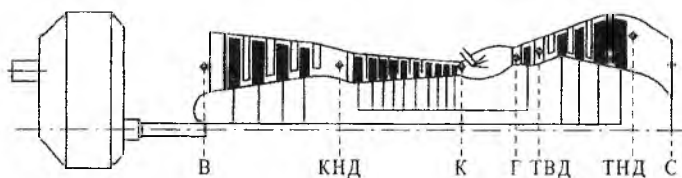
Рис. 5.1. Схема проточной части ТВВД – прототипа
