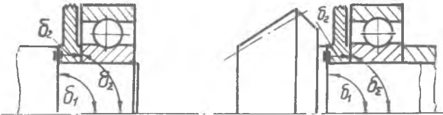
Рис. 10. Подшипник и торец разделены кольцом кольца \delta_2 и биения торца заплечика \delta_1 , являющегося искомой ве- личиной, определяемой расчетом.
