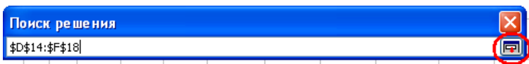
Рис. 12. Вид диалогового окна Поиск решения после указания ячеек, в которых находятся проектные переменные
