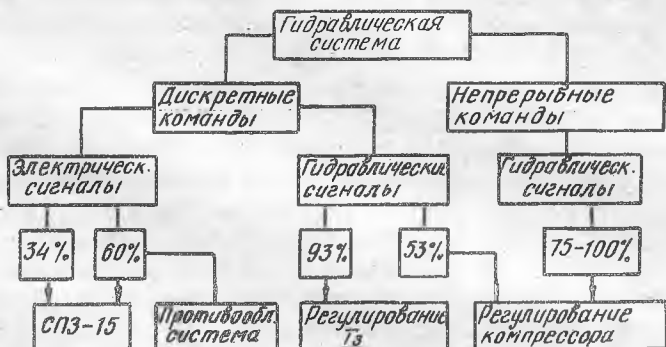
Р и с. 10. Структура команд такогидравлической системы двигателя ТВ2-117
