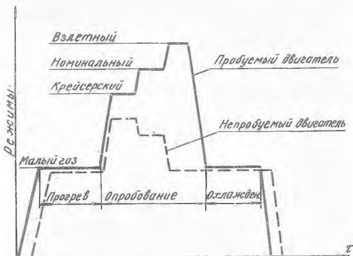
Р и с. 25. График прогрева и опробования двигателя на вертолете
