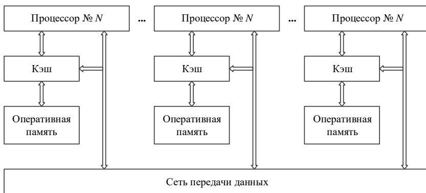
Рис. 2.3. Архитектура мультипроцессорной системы с неоднородным доступом к разделяемой памяти
