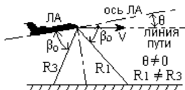
Рис.2.72 Влияние углов ориентации ЛА на точность измерений в многолучевых ДИСС:
