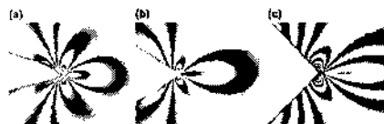
Рис. 10. Картина изохром от диаметрально сжатого бразильского диска вблизи его острого угла для ( \beta = 0 ) a) \gamma = 30^\circ , b) \gamma = 60^\circ , c) \gamma = 90^\circ
