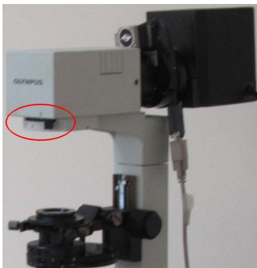
Рисунок 5.5 – Ирисовая диафрагма галогеновой лампы
