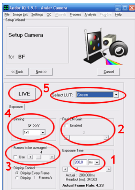
Рисунок 5.14 – Задание настроек камеры и вывода изображения: 1 – выбор времени экспозиции; 2 – управление электронным усилением; 3 – управление покадровым усреднением; 4 – сложение пикселей; 5 – запуск отображение изображения; 6 – режим отображения изображения
