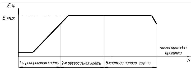
Рис.5. Схема распределения обжатия по проходам прокатки
