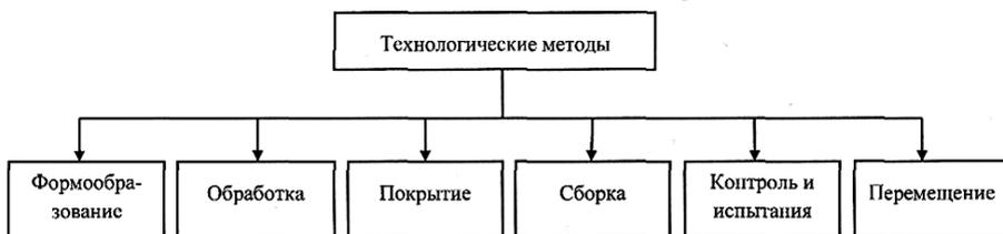
Рис. 2.3. Классификация технологических методов
