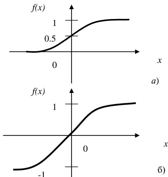
Рис. 2.7 Графики сигмоидальных функций:
