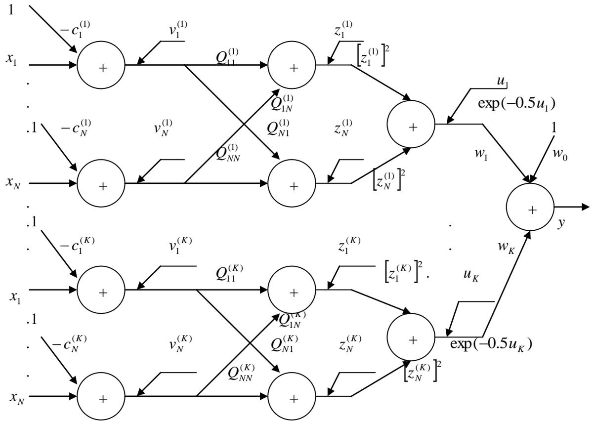
Рис. 4.4 Детальная структура радиальной сети *HRBF* с произвольной масштабирующей матрицей  $Q$
