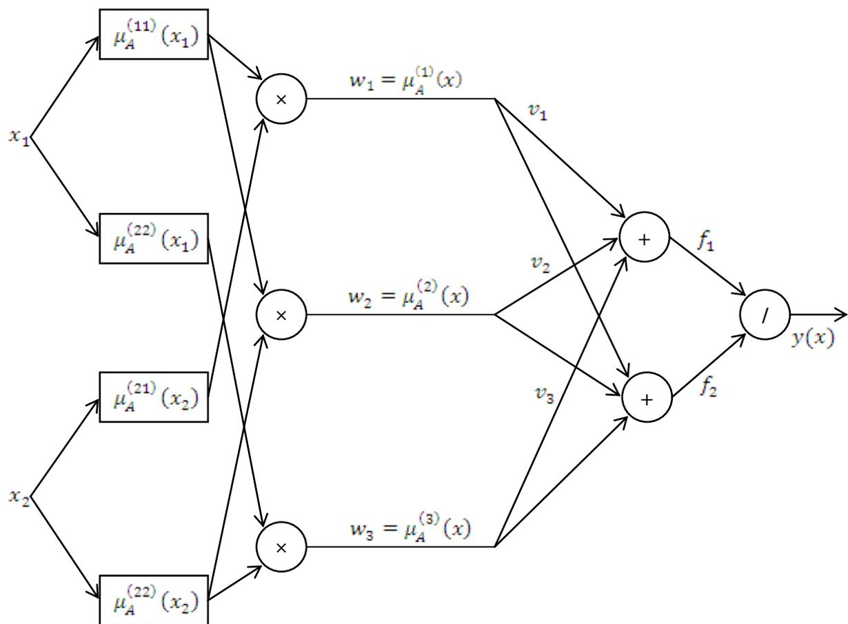
Рисунок 8.5 Структура нейронной сети Ванга-Менделя с числом правил, большим числа классов принадлежности
