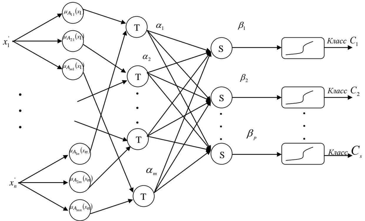
Рисунок 8.13 Структура гибридного нейронечеткого классификатора
