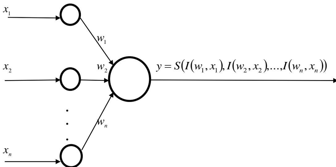
Рисунок 8.10. Структура нечёткого нейрона «Импликация -ИЛИ».
