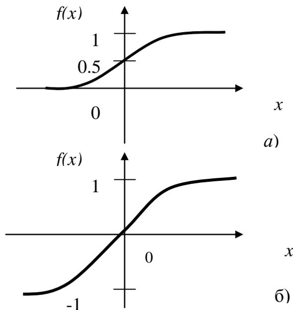
Рис. 1.5 Графики сигмоидальных функций:
