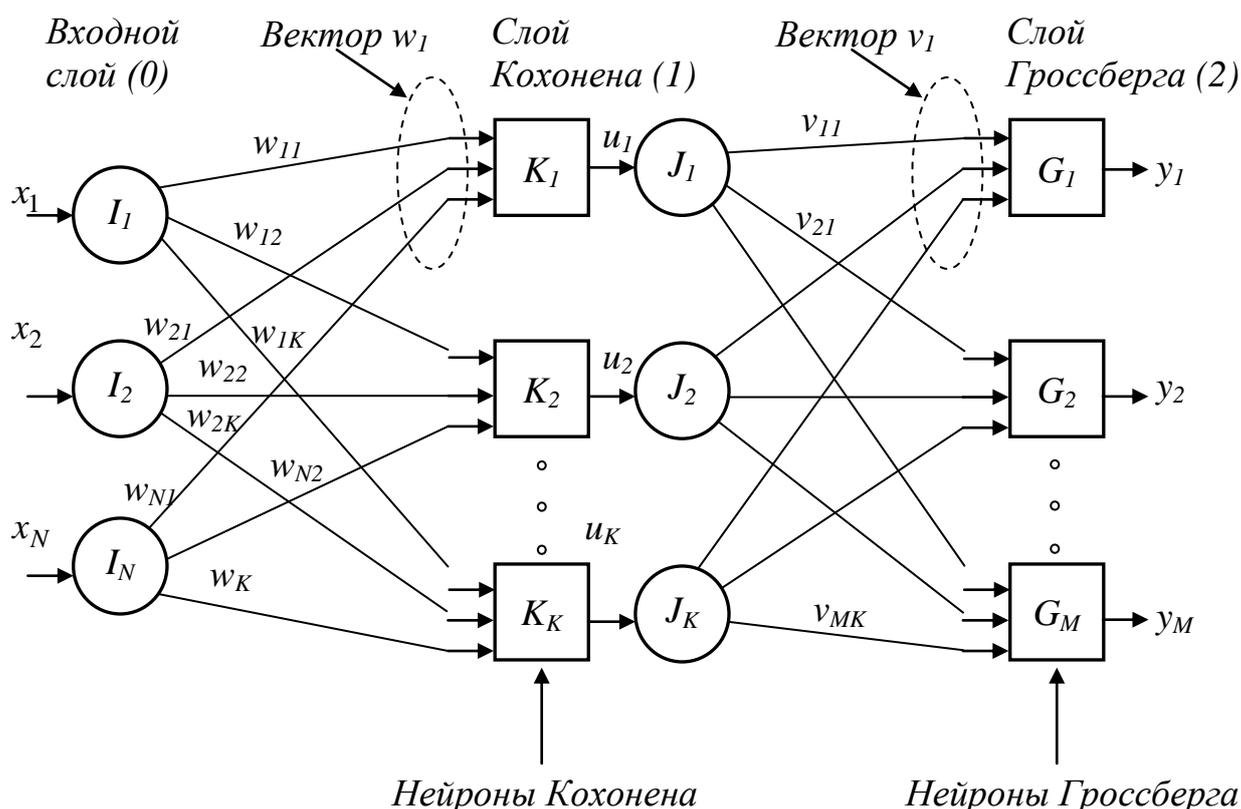
Рис. 4.2 Сеть обратного распространения без обратных связей
