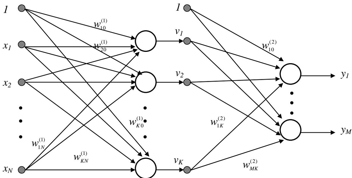
Рис. 2.2 Обобщенная структура двухслойной сигмоидальной нейронной сети
