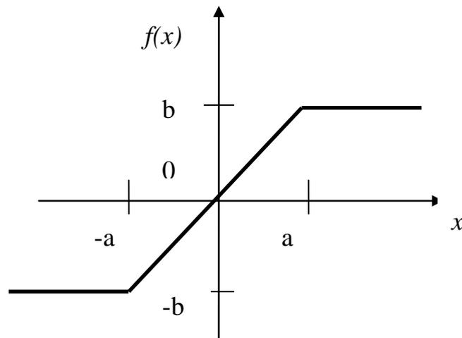
Рис. 1.9 График линейной с насыщением функции активации
