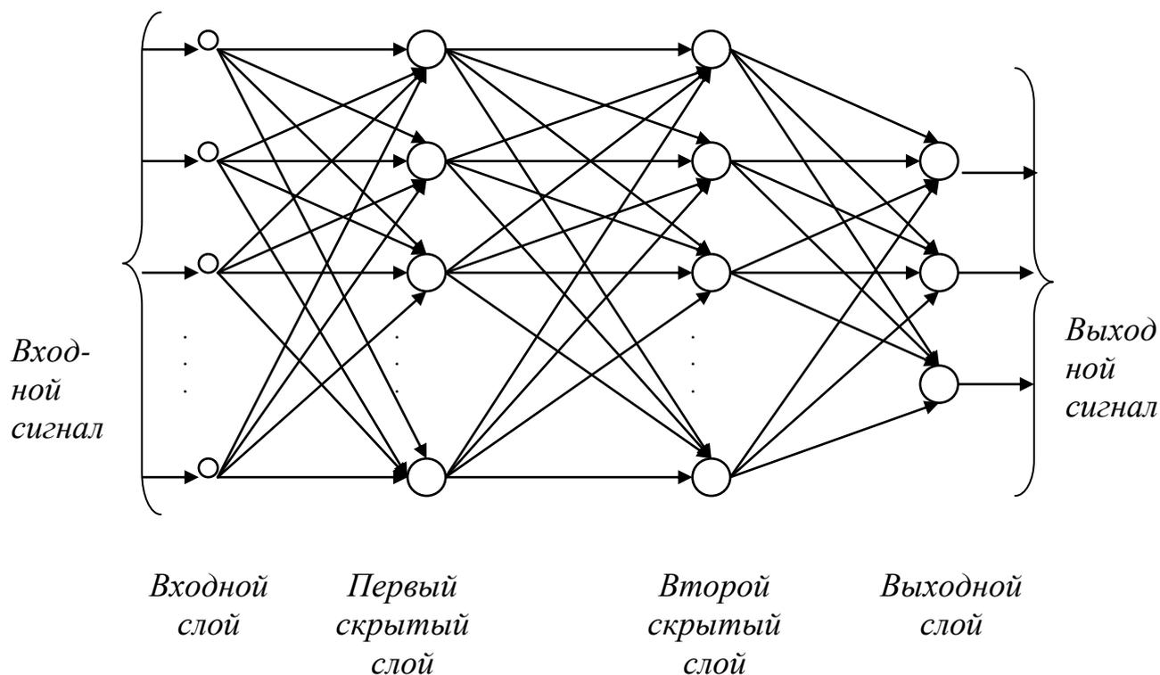
Рис. 2.1 Структура многослойного персептрона с двумя скрытыми слоями
