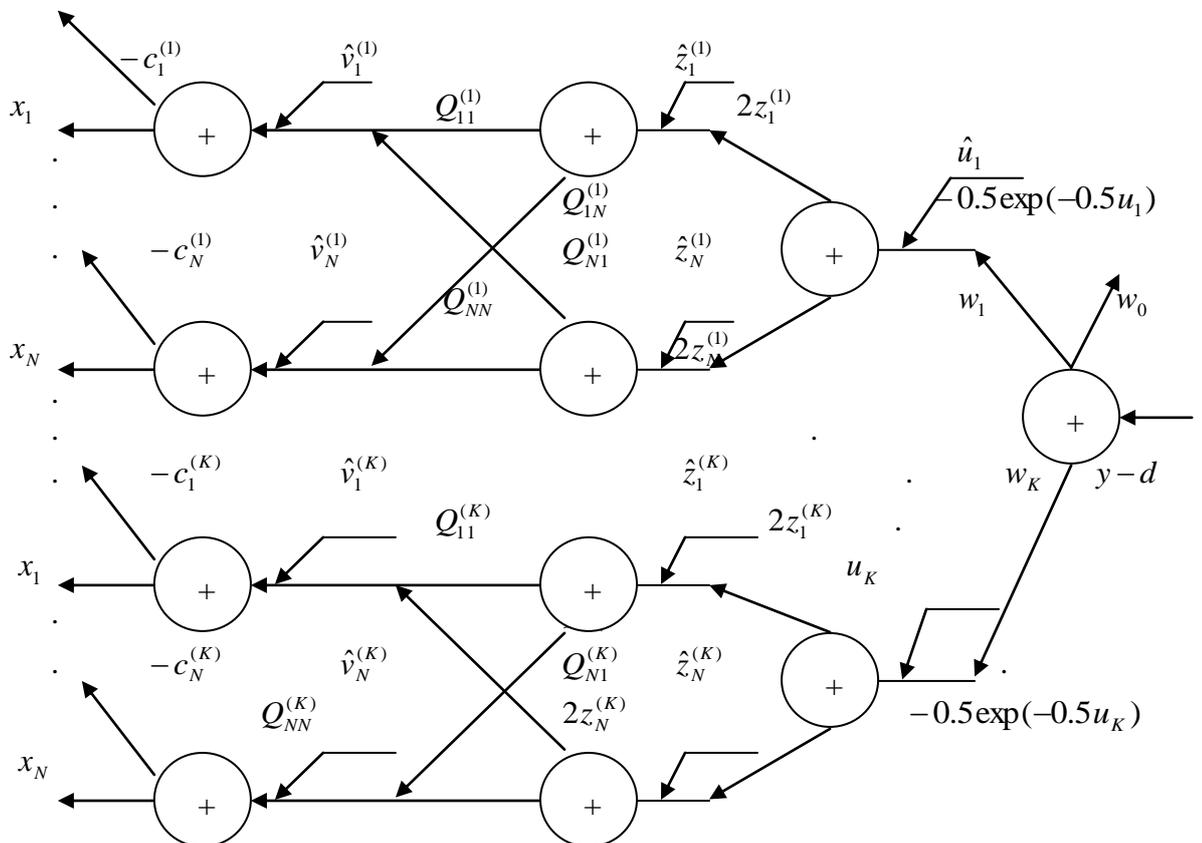
Рис. 4.5. Структура сопряженной HRBF-сети, используемая для расчета градиента
