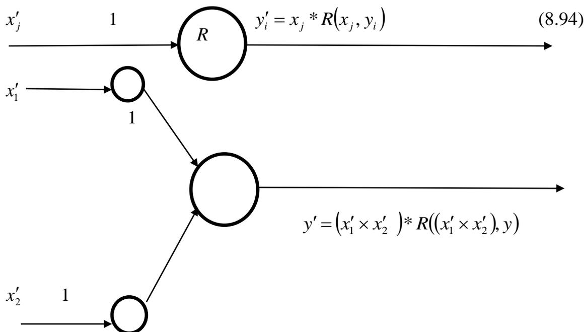
Рисунок 8.11. Примеры структур нечётких нейронов для композиционных правил вывода.
