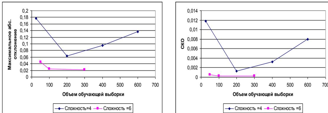
Рис. 6.8 Зависимость СКО и максимального абсолютного отклонения от объема выборки, соотнесенного со сложностью сети
