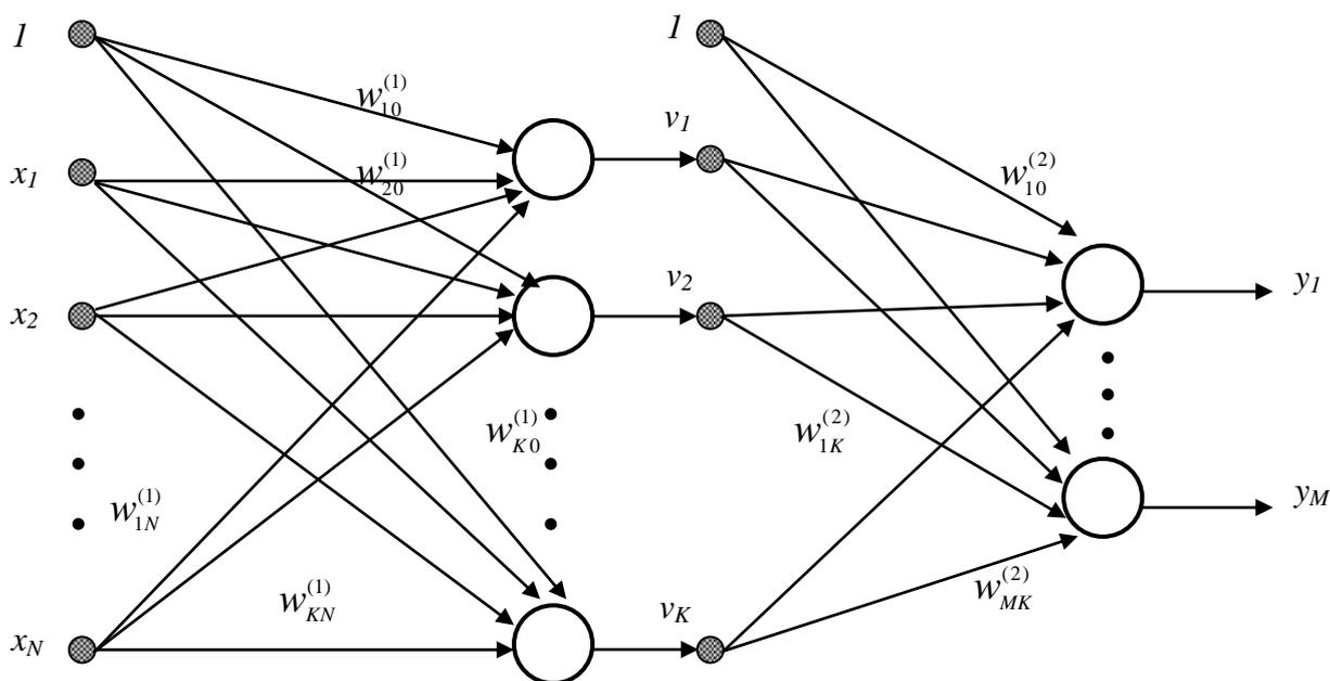
Рис. 3.2 Обобщенная структура двухслойной сигмоидальной нейронной сети
