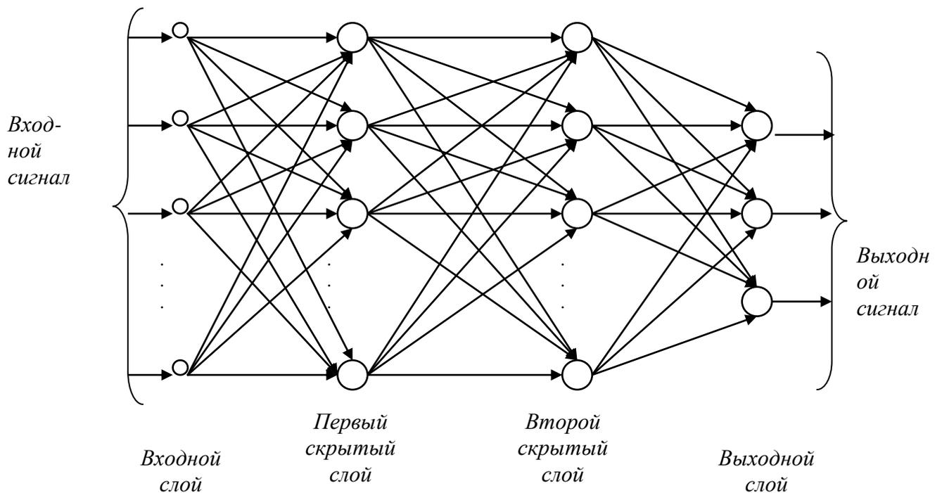
Рис. 3.1 Структура многослойного персептрона с двумя скрытыми слоями
