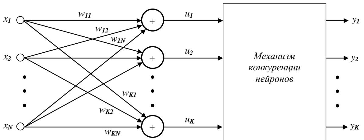
Рис. 2.8 Схема соединения нейронов типа *WTA*
