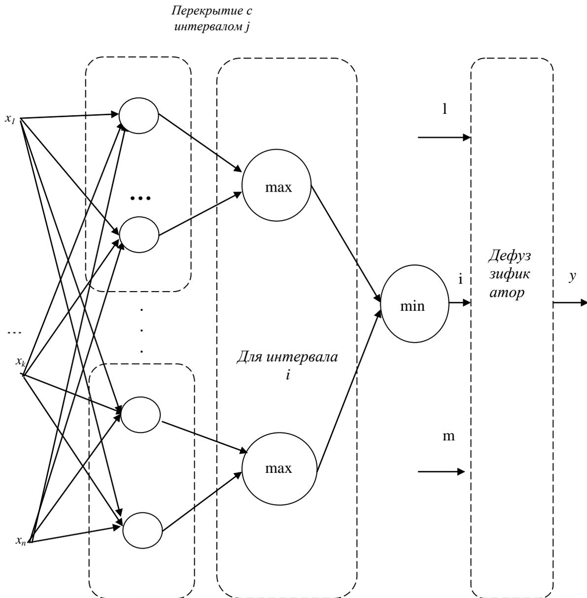
Рис.8.15 Структура гибридной нейронной нечёткой сети Абе и Лэна для извлечения нечётких правил из данных при решении задачи аппроксимации функции
