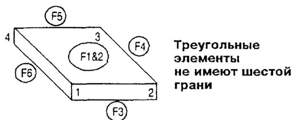
Рисунок 5.6. Плоские конечные элементы. Нумерация
