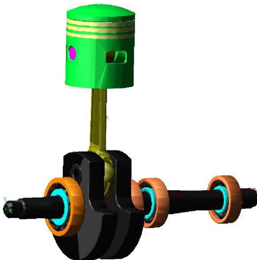
Рис. 4. Упрощенная модель двигателя Д300
