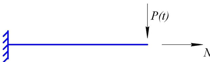
Рисунок 3.3 – Нагружение балки силами  $P(t)$  и  $N$
