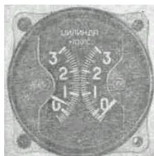
Рис. 128. Указатель двояного термометра 2ТЦТ-47 температуры 1-го и 9-го цилиндров
