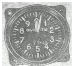
Рис. 129. Указатель тахометра ТЭ-45
