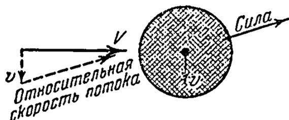
Рисунок 96 – При движении провода вниз горизонтальный боковой ветер имеет кажущееся направление наклонно снизу
