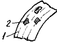
Рис.10 Вид линии на дебаеграмме в крупнозернистом материале
