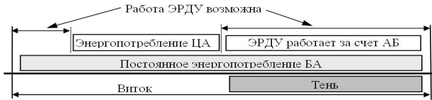
Рис. 3.21. Схема работы ЭРДУ на витке
