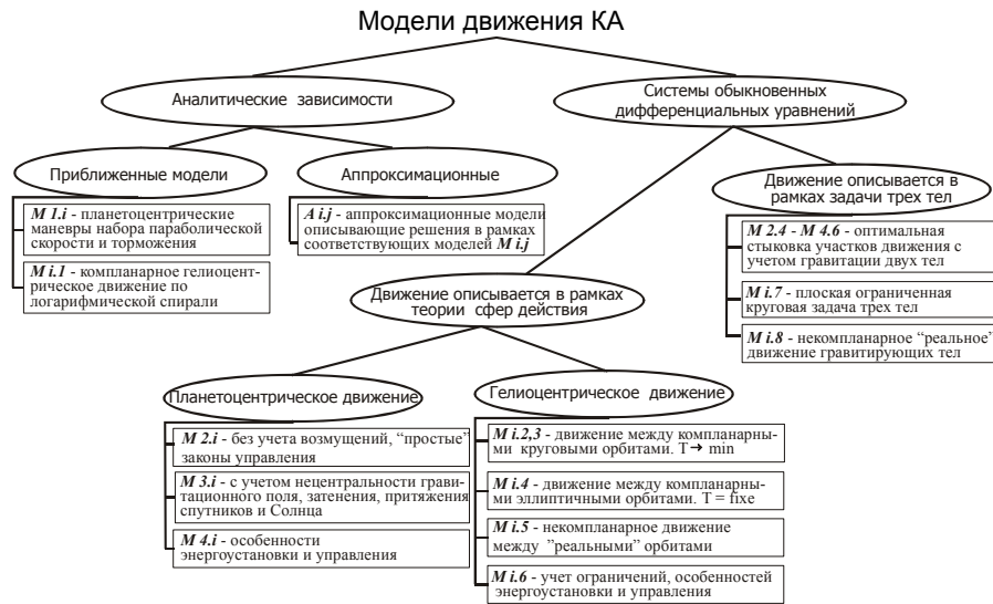
Рис. 3.44. Структурная схема моделей движения КА, использующихся для решения баллистической части задачи оптимизации межпланетных миссий
