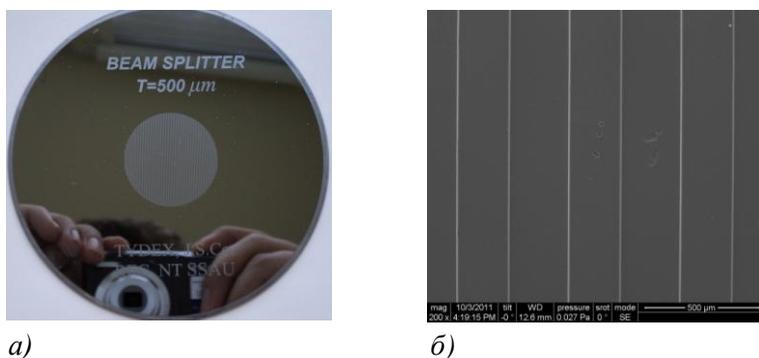
**Рис. 2.7.** Делитель пучка (а – общий вид, б – результат исследования микрорельефа с помощью растрового электронного микроскопа)
