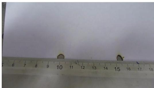
*Рис. 2.9. Результат взаимодействия терагерцового излучения с бумагой в +1-м и -1-м дифракционных порядках делителя пучка*
