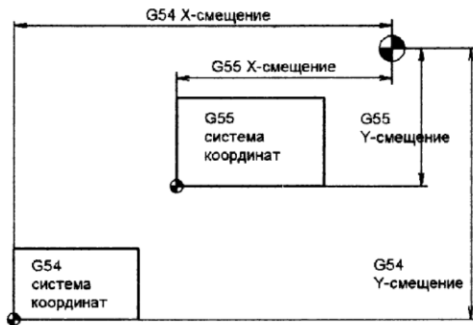
Рисунок 5.6 - Многие станки с ЧПУ позволяют устанавливать несколько рабочих систем координат.
