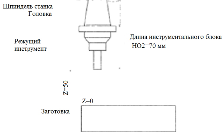
Рисунок 5.9 - Если нужно переместить инструмент в Z50 и в программе есть код компенсации длины инструмента, то режущая кромка фрезы не дойдет до поверхности детали ровно 50 мм
