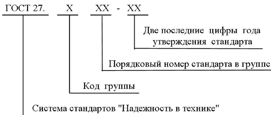
Рис. 1.3. Схема обозначений стандартов по надежности
