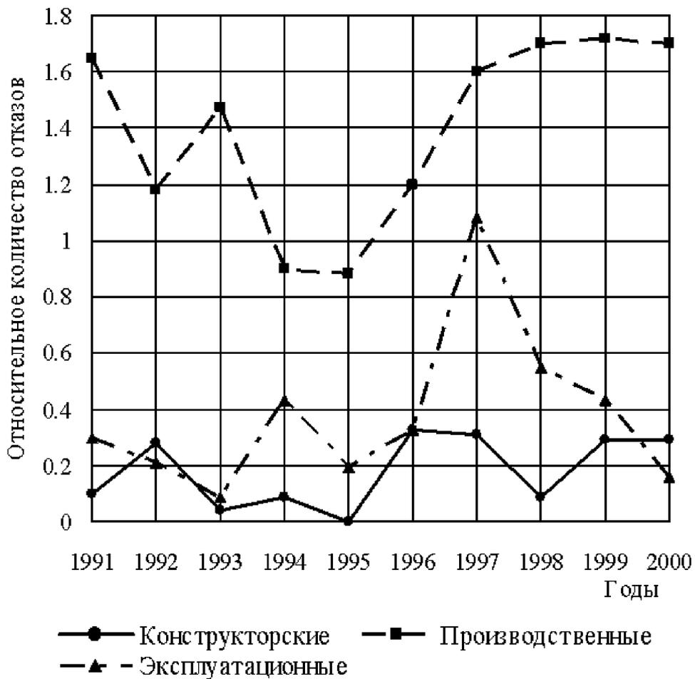
Рис. 1.1. Распределение отказов серии ракет-носителей по различным причинам
